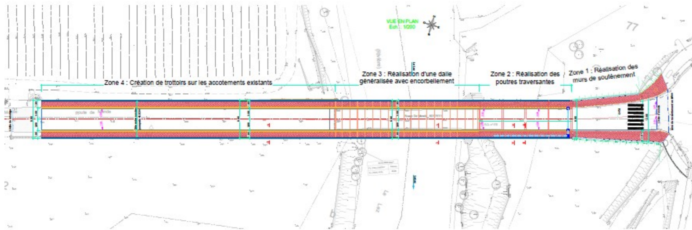
Coupe lors Ouvrage Etre Gauche Zone 1 : Réalisation des murs de soutènement pour la création des trottoirs
